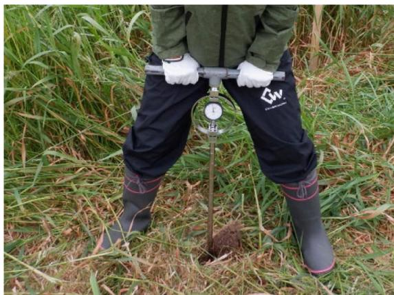
写真-3 コーンペネトロメータ試験状況
