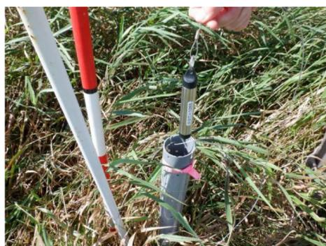
写真-1 地下水位計設置状況
