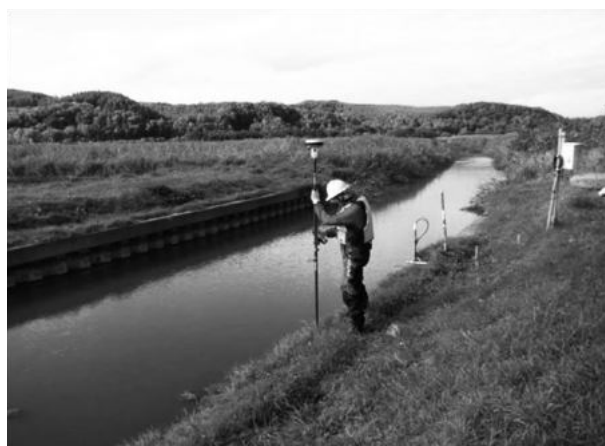
写真-3 測量調査(メッシュ測量:GNSS)
