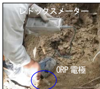
写真-13 酸化還元 (Redox) 電位調査の様子
