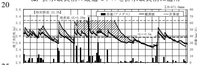
(b) 排水改良前の最適モデルを排水改良後に適用
