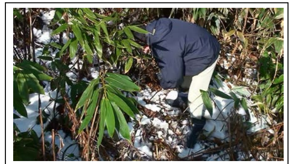
写真-5 音聴棒による音聴調査状況
