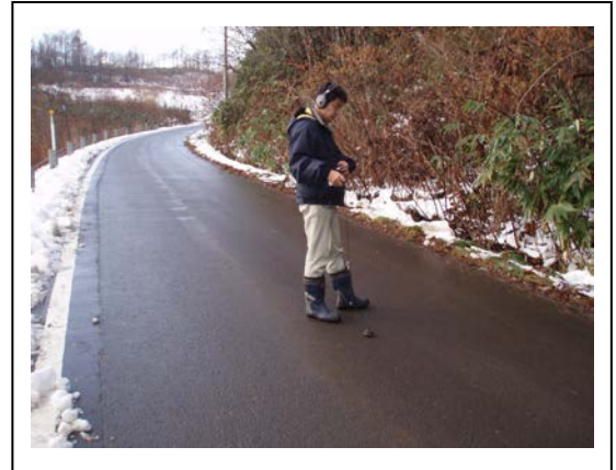
写真-4 漏水探知機による音聴調査状況
