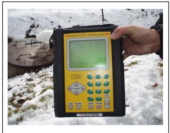
写真-3 装置本体による音圧信号の受信・解析状況
