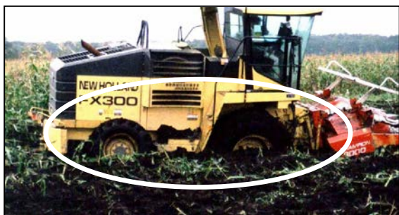
【写真－1 走行不能になったハーベスター】
